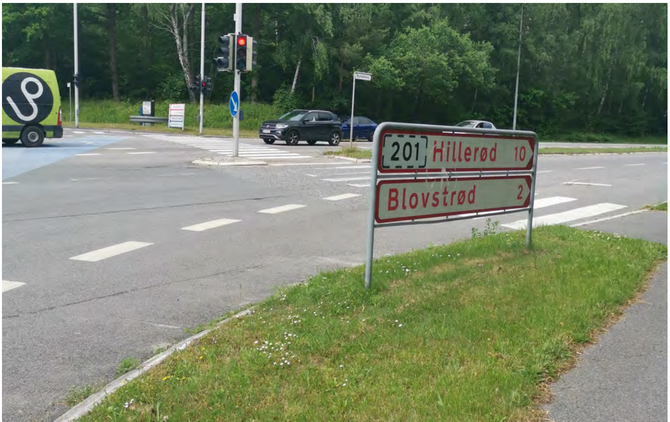
Vejvisningstavler ved fodgængerfeltet nord for krydset kan skjule fodgængere.
