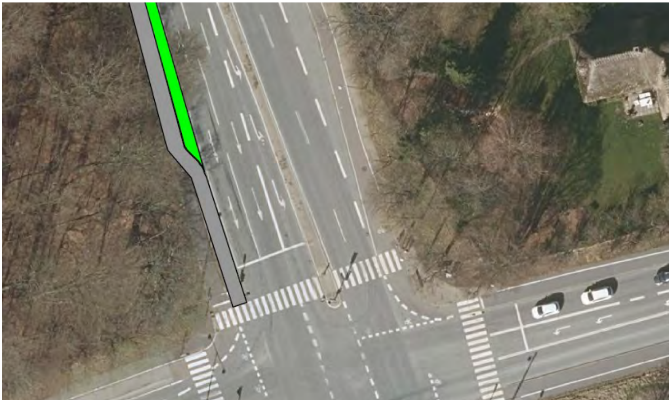
Princip for nedlæggelse af skillerabat, hvorved cykelstien bliver ført helt ud til kørebanelen.
