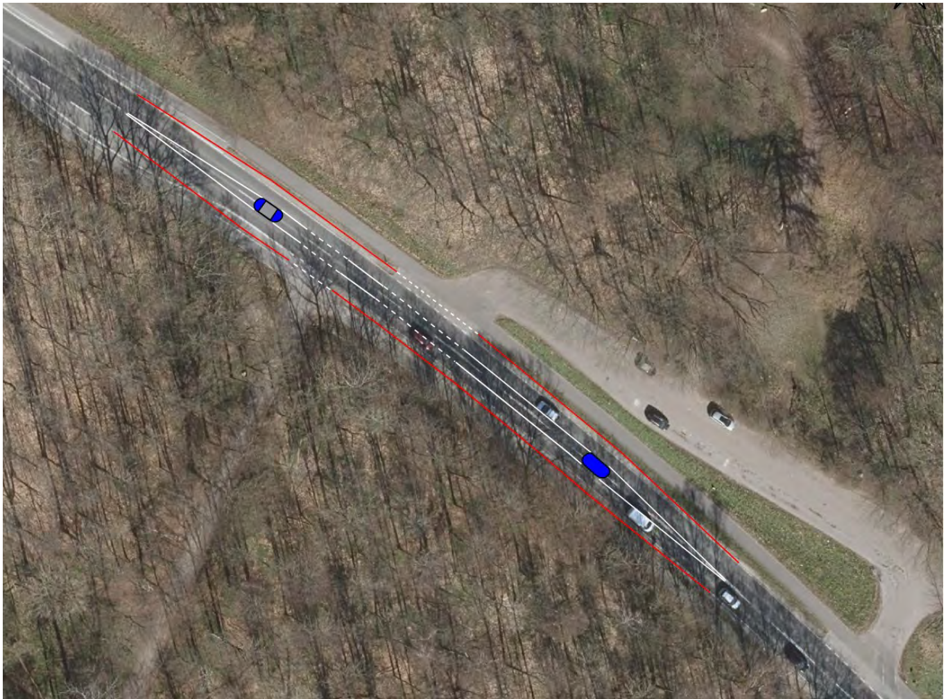
Princip for midterheller og midterfelt på Slangstrupvej ved Engledsvej.
