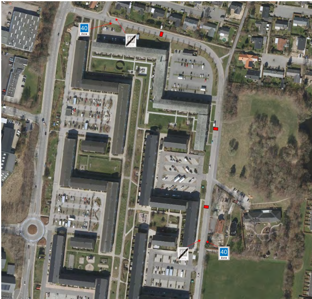
Anbefalet område med fartdæmpning (40 km/t) i form af tre cirkelformede bump.
