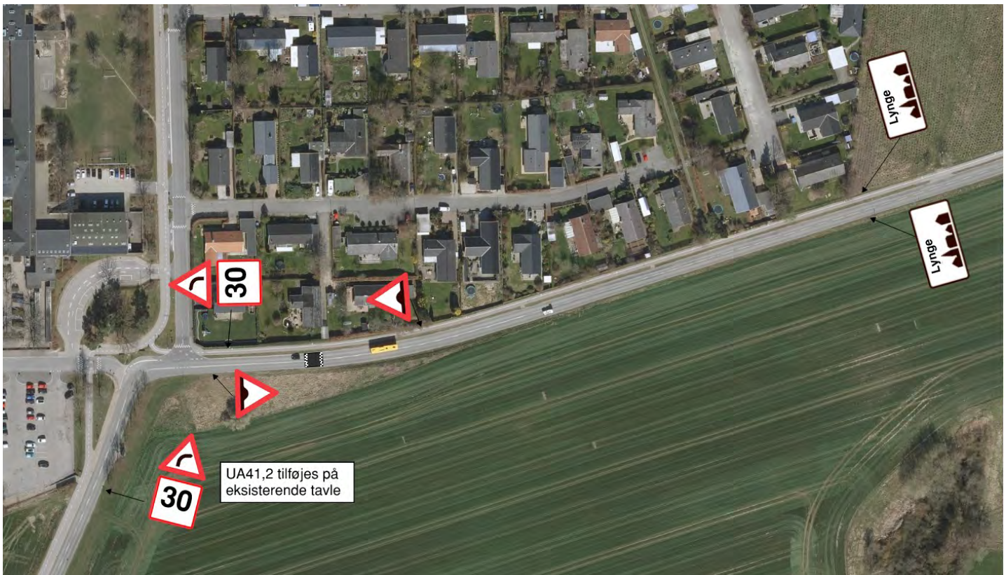
Bump og advarselstavler samt forstærkning af byport på Lyngvej.
