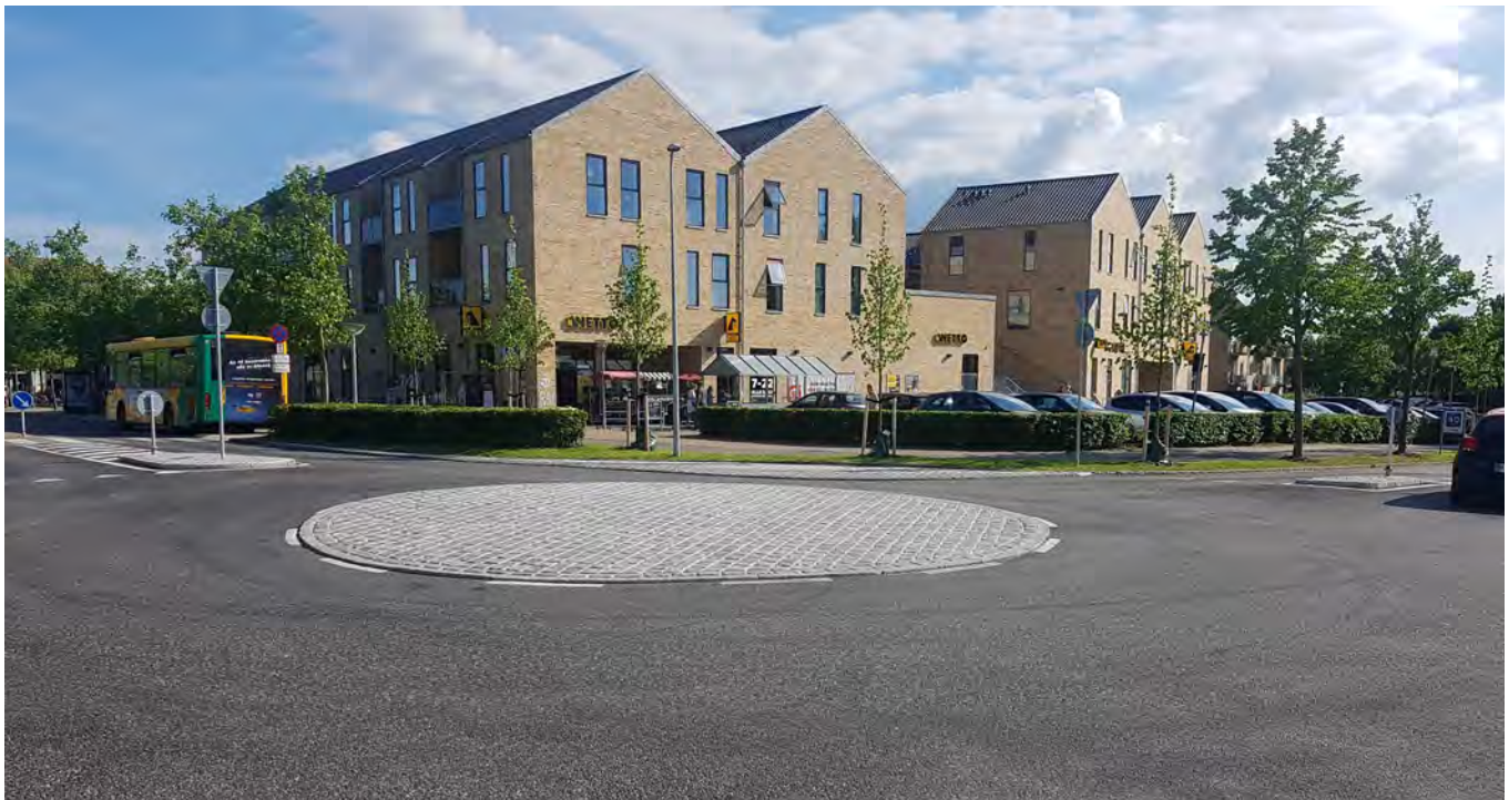
Eksempel på overkørbare arealer i en rundkørsel (Allerød Stationsvej/Lilledal).
