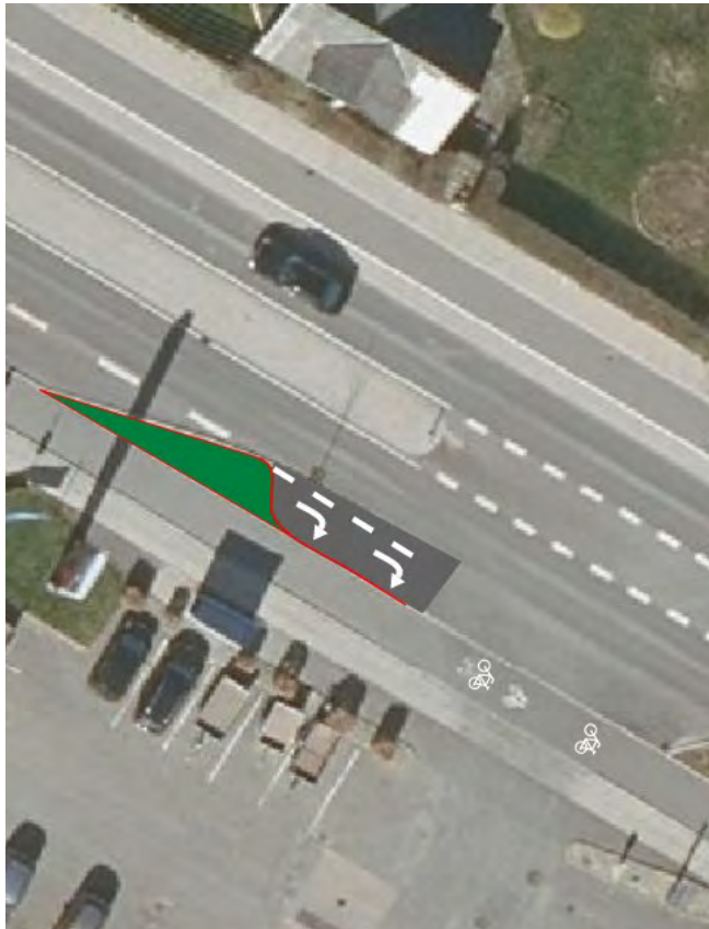
Nedlæggelse af skillerabat og etablering af højresvingsbane i stedet. Til venstre: Ved Rema 1000. Til højre: Ved Circle K.
